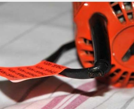
**Abb. 4:** Schadhafte Netzleitung
