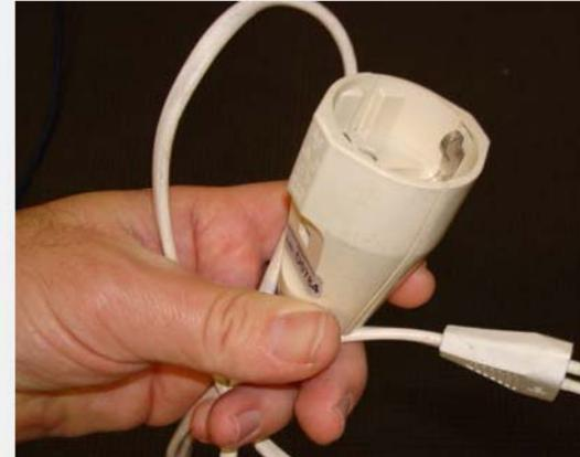
**Abb. 3:** Selbstgebastelte elektrische Verlängerungsleitung ohne Schutzleiter
