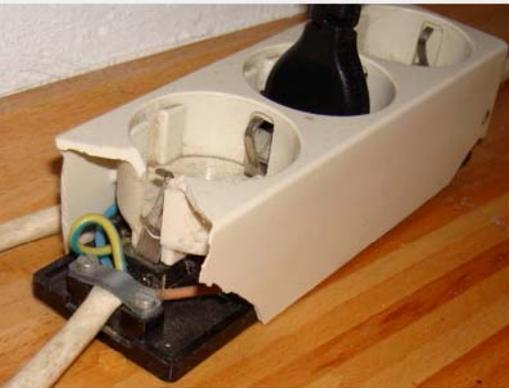
Abb. 10: Unter einem Elektrobett zerdrückte Tischsteckdose
