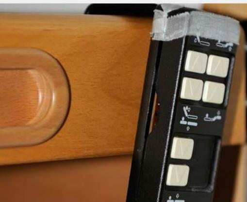
**Abb. 7:** Laienhafte Reparaturen von Bedienteilen an Elektrobotten
