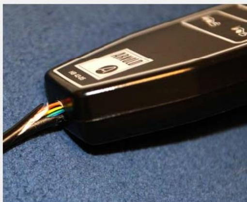
**Abb. 8:** Defekte Kabel an Bedienteilen von Elektrobotten
