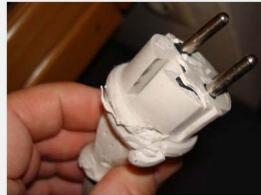
Abb. 12: Beschädigter Netzstecker durch Bewegung eines Elektrobettes
