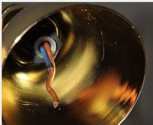
**Abb. 5:** Fehlende Lampenfassung mit blanken stromführenden elektrischen Leitungen
